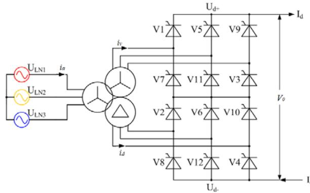
**Figure 3:** The twelve-pulse rectifier
