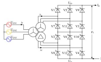
Figure 3: The twelve-pulse rectifier
